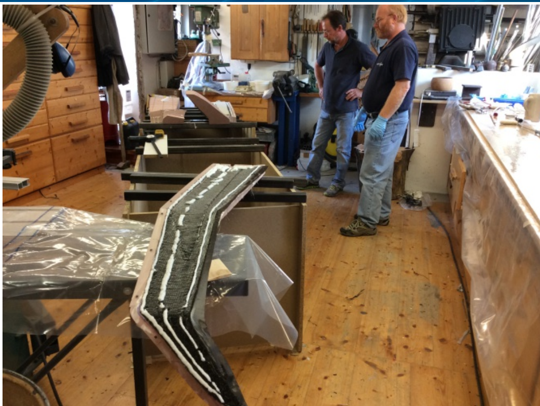
Urmodelle des Aussenflügels vor dem Schließen
