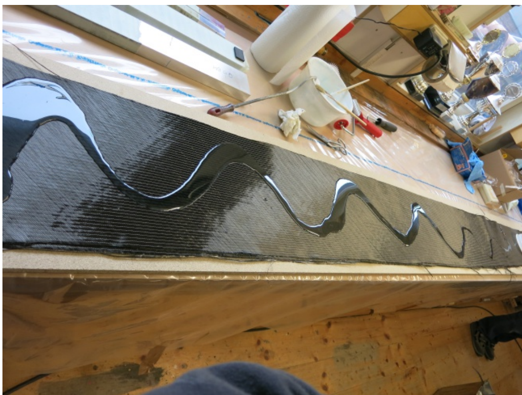
Urmodellbau: Tränken des Carbon-Geleges
