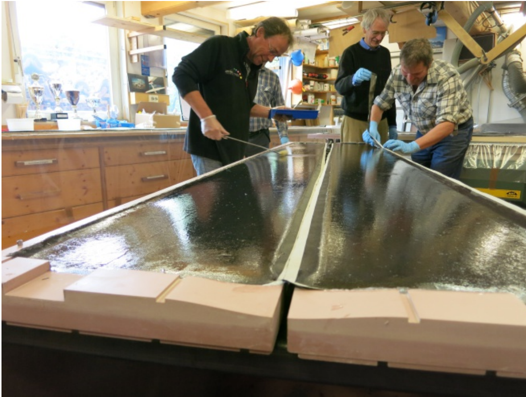
Urmodellbau: Einlegen des Carbon-Geleges in die CNC-gefrästen Negative der Tragflächenmittelteile
