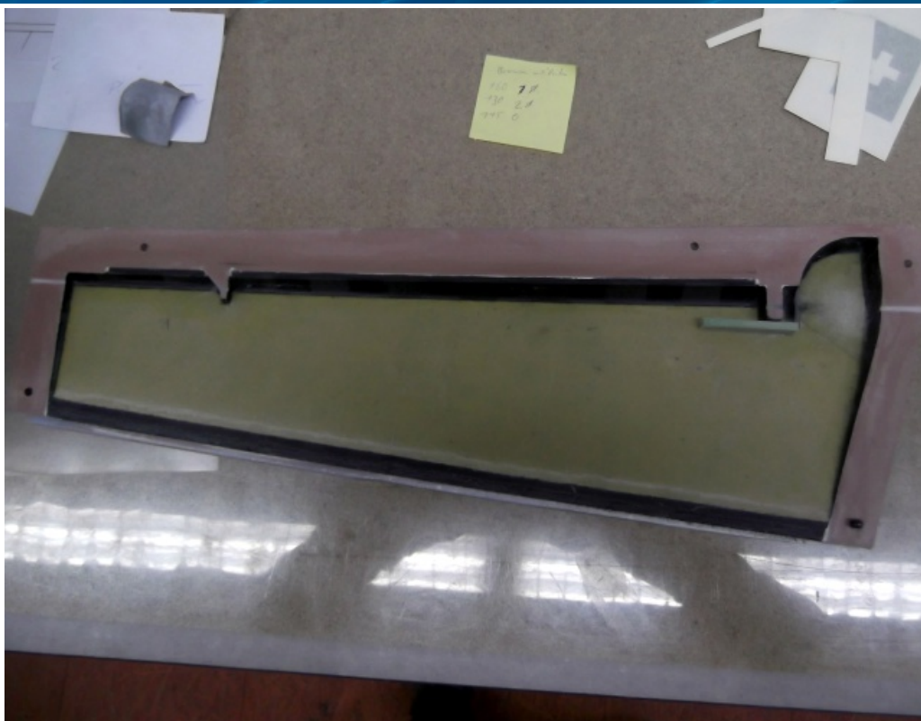
CNC-gefräste Seitenruderform für das Urmodell
