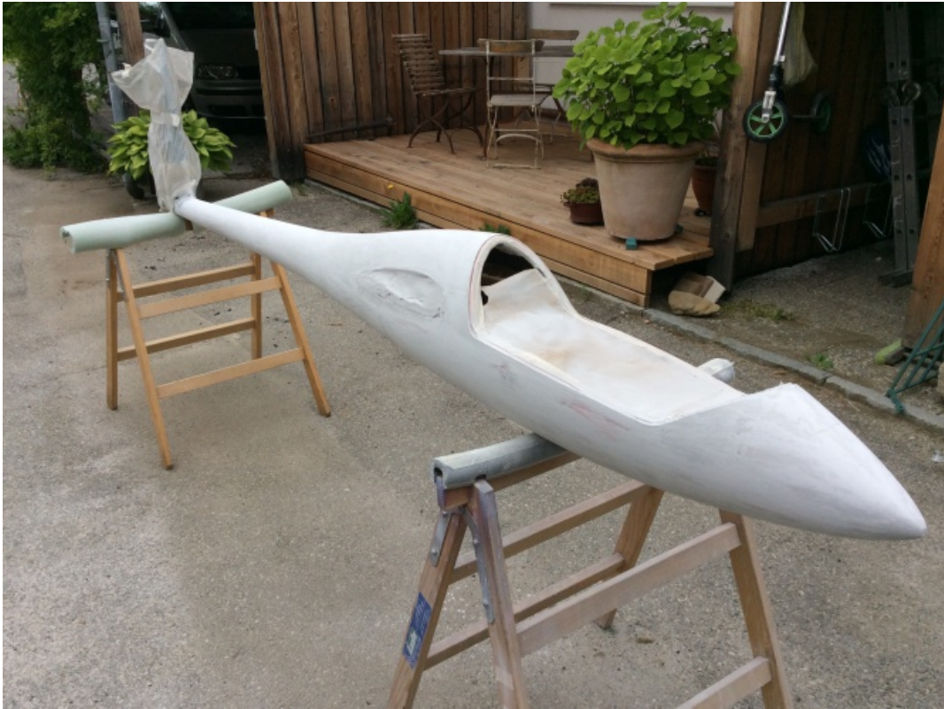
Entstehung des Rumpf-Urmodells 1
