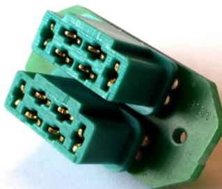
Die MPX Schraubenhalterplatine bietet die ideale Möglichkeit MPX-Stecker am Flügel oder Rumpf zu befestigen. Die Platine wird auf die Pins des MPX-Steckers gesteckt und verlötet. Befestigen können Sie die Platine entweder mit normalen Blechschrauben, oder mit Gummitüllen und Schrauben (aufbohren erforderlich).
